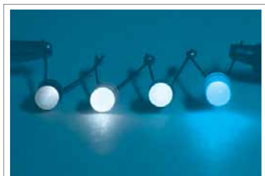
▲ شکل ۱۶. این LEDها به‌طور متوالی وصل می‌شوند به‌طوری که جریان یکسانی به ترتیب از آن‌ها می‌گذرد. ولی، گاف نواری متفاوت آن‌ها باعث می‌شود که نور با رنگ‌های متفاوت گسیل کنند.
